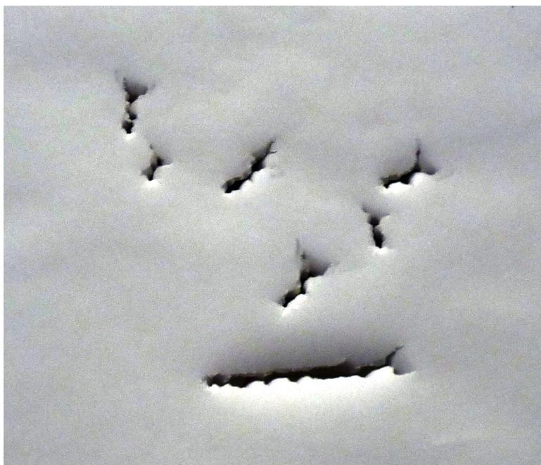
*Die unterschiedlichen Einrisse beim Papiertest geben Hinweise auf die Bewegung des Pfeils kurz nach dem Abschuss, Fehler in der Höhe des Nockpunkts oder sind auch Hinweise auf Schießfehler. Fälschlich werden unpassende Pfeile oft durch die Änderung des Zielbildes oder der Abschussbewegung ausgeglichen.*
